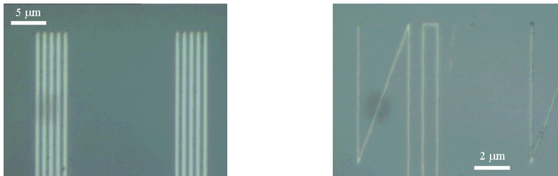
Figura 3. Ejemplos de litografías submicrónicas realizadas con el procedimiento desarrollado en este proyecto. En a) se tienen líneas de 0.5 \mu\text{m} separadas 0.5 \mu\text{m} y en b) las líneas son de menos de 200 nm.
