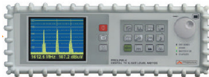
Figura 15. Caracterización de la red de distribución mediante la prueba de los tres tonos.
