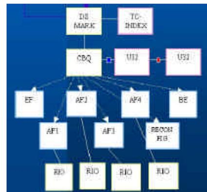
un árbol de calidad de servicio mediante las funciones de control de tráfico del TC API. Ese árbol tiene una forma como el de la figura de arriba a la derecha.
