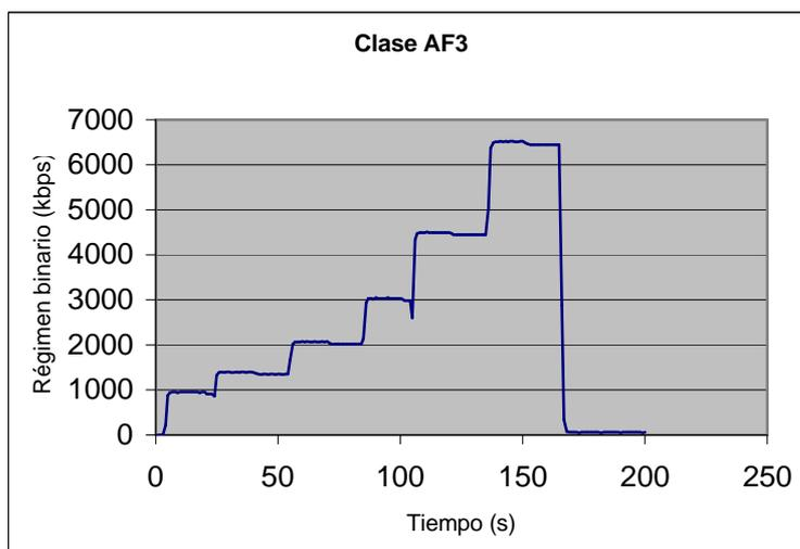
La clase comienza con un ancho de banda de 900kbps (400+300+200kbps). Los valores teóricos de los escalones según el factor que aplica el BB serán: 900, 1350, 2025, 3037, 4556, 6834kbps y finalmente, antes de que llegue al máximo (10000 kbps), se desinstaló la conexión del BB por lo tanto el Router la clasificó como Best-effort de 50kbps. El resultado es el que tenemos en la gráfica y es bastante fiel a los cálculos teóricos.
