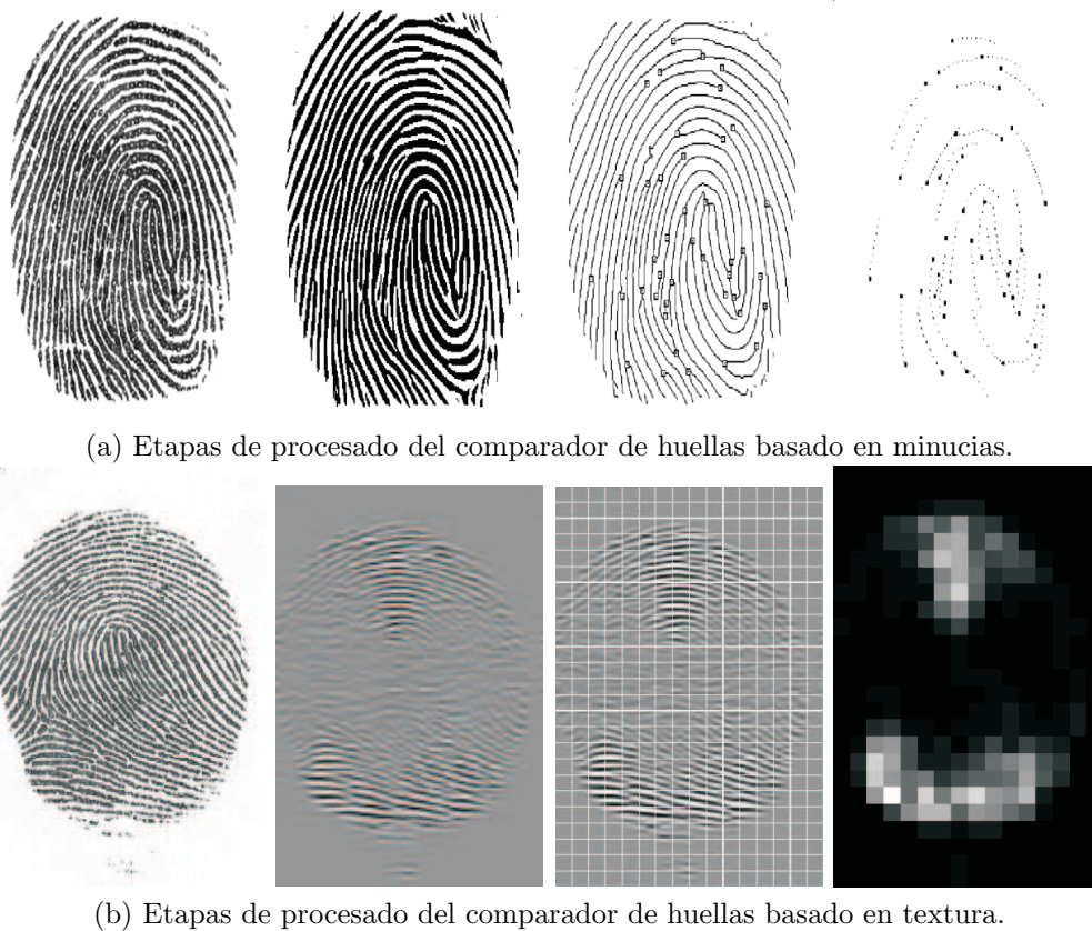
Figura 3: Verificación multi-algoritmo de huella dactilar. Sistemas de verificación de huella dactilar utilizados en la Tesis.
