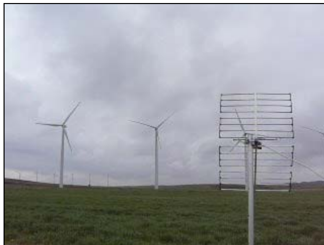
Fig. 2.6. Medida del scattering de un parque eólico para el análisis de la viabilidad de situar un repetidor de TV cerca del parque eólico.
